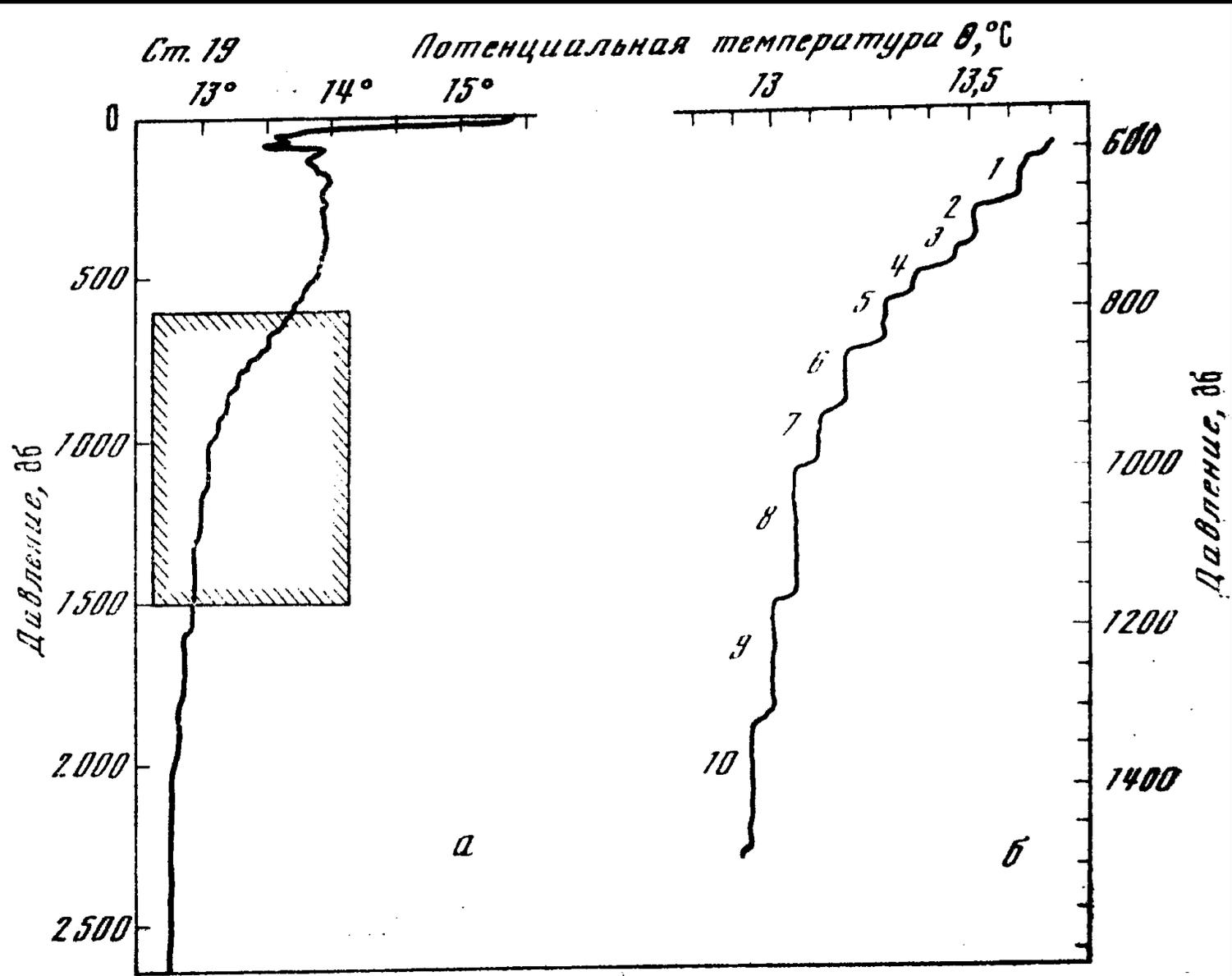
Рис. 8. Пример ступенчатого вертикального профиля температуры
